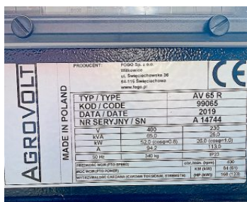
Dieses Notstromaggregat liefert 65 kVA bei 400 V. Es ist mit Schutzklasse IP 23 nur für den Betrieb im Trockenem geeignet.
